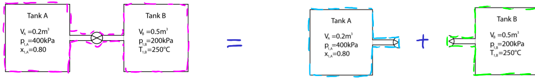
Abbildung 1: Tank A und B im Zustand 1
